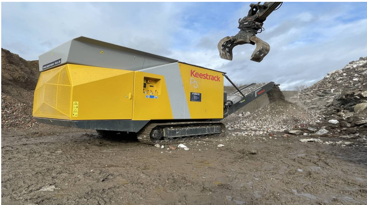
Rysunek. Przykładowe urządzenie - rozdrabniacz do przetwarzania destruktu firmy Keestrack
